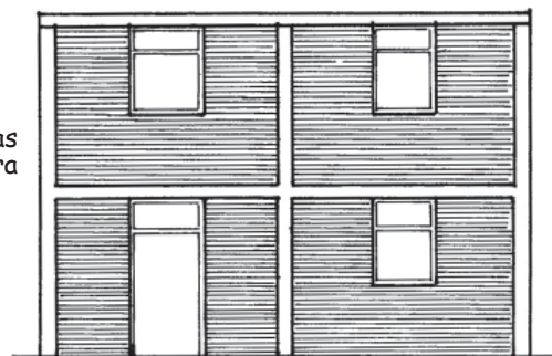
Vanos de ventanas y puertas bien ubicados
