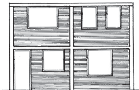
Vanos de ventanas y puertas mal ubicados
