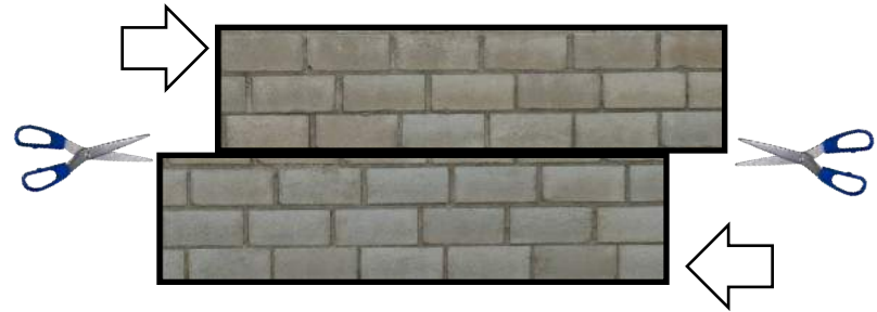
Muro de corte
